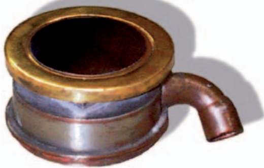
Der erste mithilfe eines Peltierelements gekühlte Wafer Chuck mit einem Durchmesser von 2 Zoll, den Erich Reitingner entwickelt hat.
