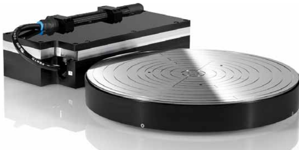
Die Thermo-Chucks vom Typ HTU Aircool AC3 stehen jetzt für die Aufnahme von Wafern mit Durchmessern von 200 mm und 300 mm zur Verfügung. Ihre Temperaturabweichung über die gesamte Fläche liegt unter \pm 0,1\text{ °C} . Die Temperaturstabilität ist besser als \pm 0,03\text{ °C} . (Bild: ERS)
